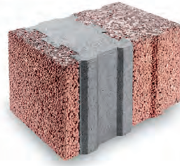
Der dreischalige Leichtbeton-Planstein NeoStone bietet einen U-Wert von 0,17 \text{ W}/(\text{m}^2\text{K}) . Damit eignet er sich für die Errichtung von KfW-Effizienzhäusern sowie Passivhäusern.
