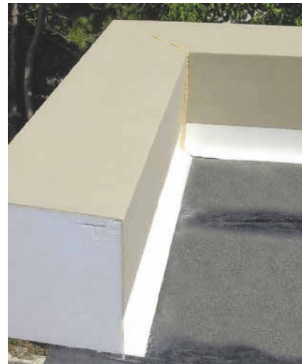
Statisch nicht beanspruchte Attika aus einem wärmedämmenden Attikaelement, das werkseitig mit Gefälle, einer witterungsbeständigen Oberfläche sowie integrierten PVC-Leisten für das Anschrauben der späteren Abdeckung ausgerüstet ist. Bild: Austrotherm
