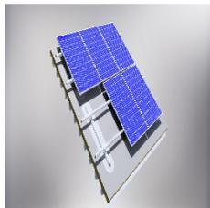
Montage einer **dachparallelen** PV-Anlage ohne Aufständering unter Verwendung von **SoloPlus** Modultragprofilen, die mittels **Rapid2+L-Halter** auf der **alwitra Montageschiene EVATEC Solar** befestigt werden. Die zusätzliche Dachlast liegt im Bereich von 14Kg/m<sup>2</sup>.
