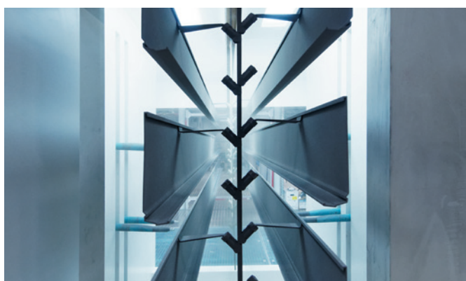
Les pistolets de pulvérisation à poudre automatique garantissent une application régulière et parfaite de la peinture
