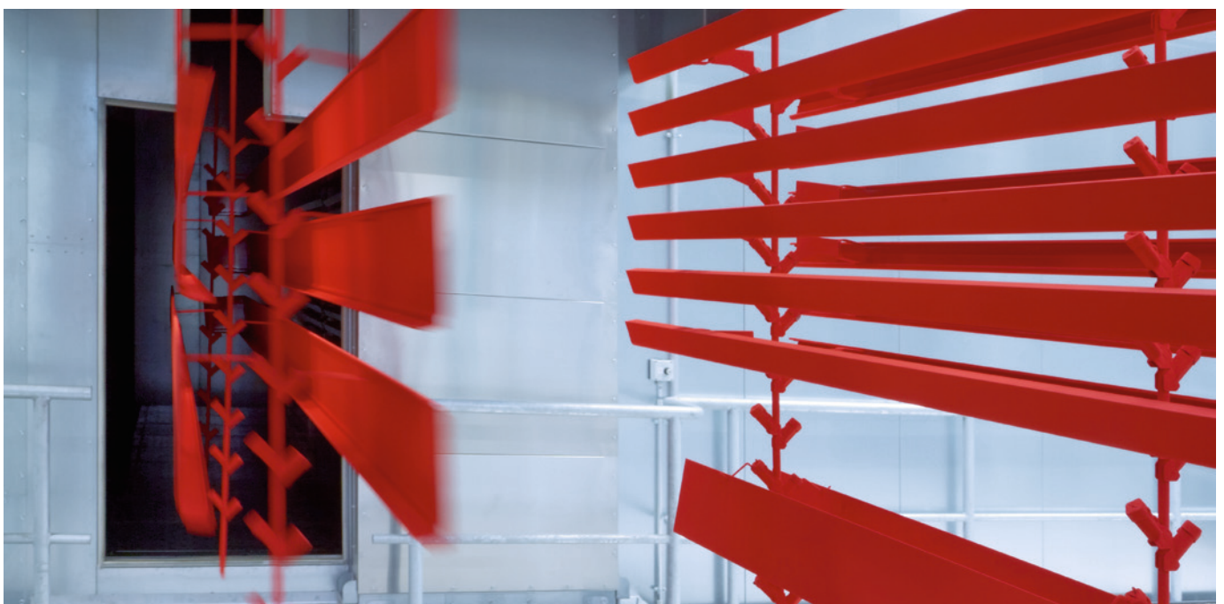
Entrée des profils revêtus dans le four
